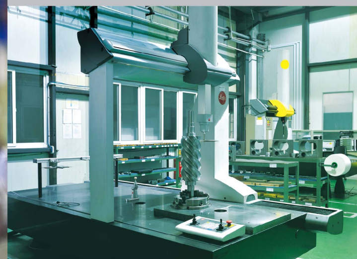
德国leitz超高精度三坐标测量仪
